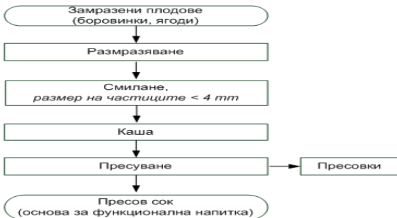
Фигура 1. Технологична схема за получаване на пресов сок от ягодоплодни
